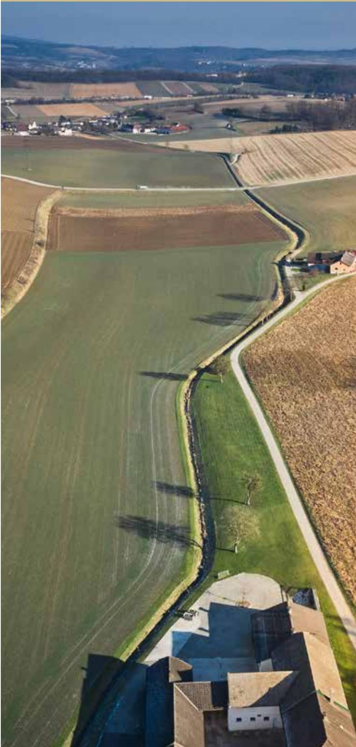
Vor und nach Pöverding sowie nach Schratzenbruck wird der Weierbach mit Retentionsbecken hochwassersicher gemacht. Die quer über den Bach verlaufende Bergbaustraße (oben im Bild) wird dazu herausgehoben. Für heuer sind geologische Untersuchungen und Gespräche mit den Grundstücksbesitzern geplant. Das Gesamtprojekt soll zudem heuer noch eingereicht werden. 50.000 Euro sind dafür im aktuellen Budget vorgesehen. Foto: Franz Gleiß
